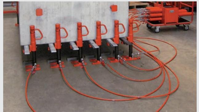
Sonderdruckblock zum synchronen Anheben mit 12 Hebegegeräten
