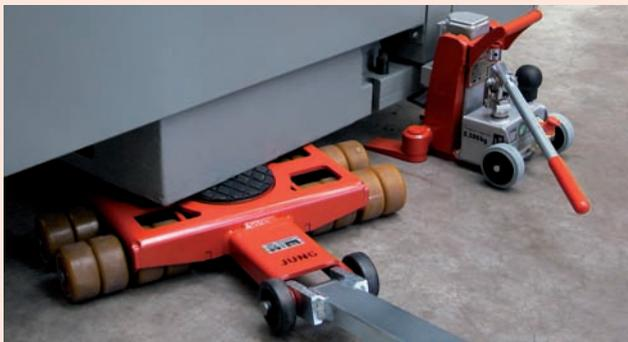
Kugelgelagerte Rollen garantieren einen leichten Lauf
